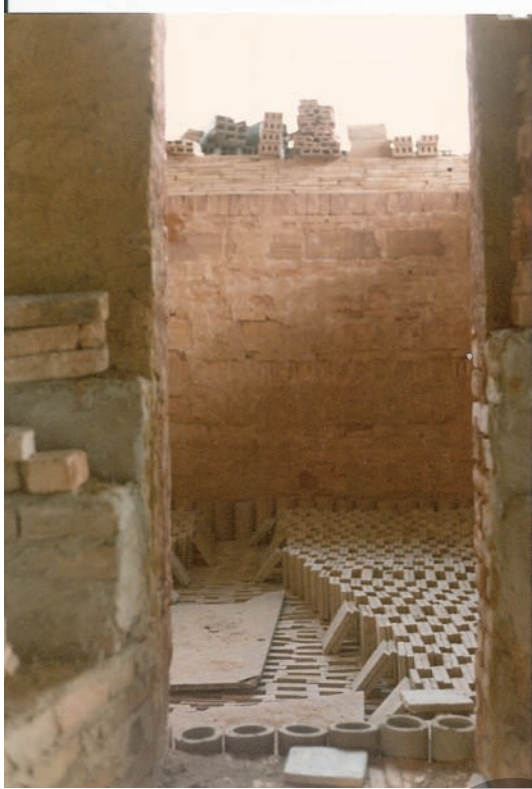
● Installation des pièces à cuire dans le four.
