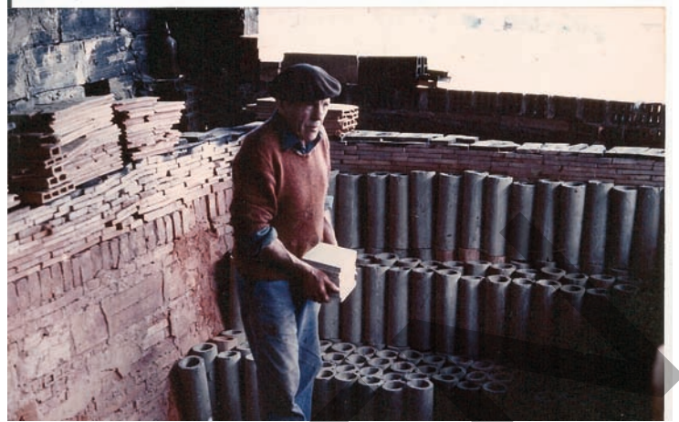
● Installation des pièces à cuire dans le four.
