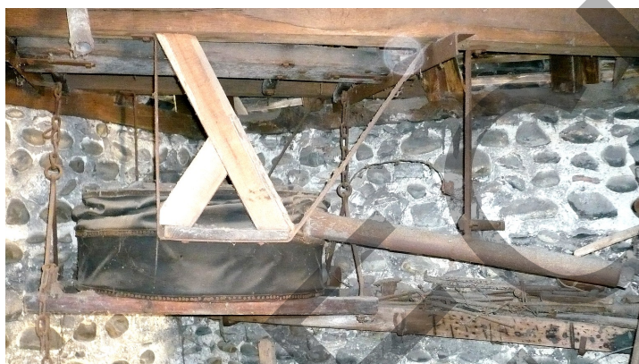
Le soufflet et l'enclume de la forge Bordenave, rue principale
